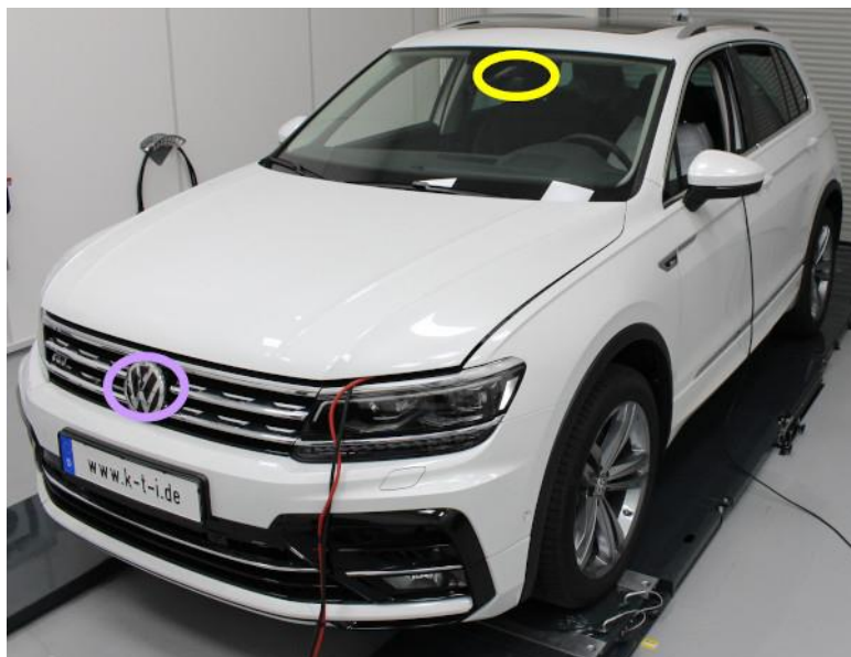
Testfahrzeug VW Tiguan mit „Multifunktionskamera“ an der Windschutzscheibe sowie Frontradar im Kühlergrill. Quelle: KTI
