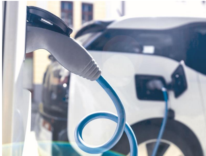
Die Prüfung der HV-Batterie kann beim System von Volytica Diagnostics auch über die Ladebuchse des Fahrzeugs erfolgen.
