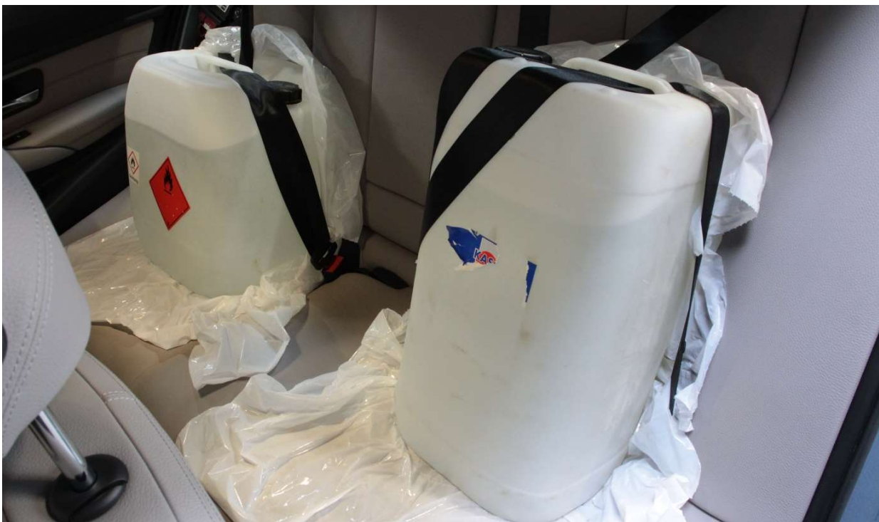
Durch Wasserbehälter auf den Rücksitzen und im Kofferraum wurde die maximale Achslast des Fahrzeugs konditioniert. Quelle: KTI.
