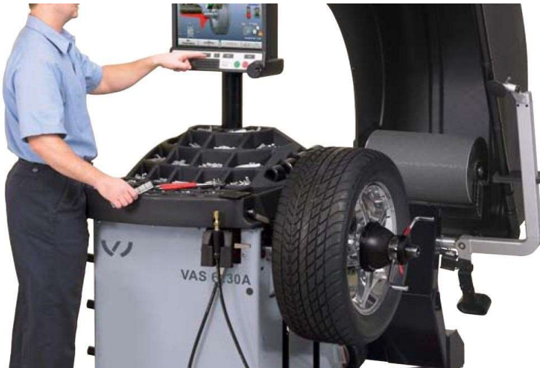
Zur Radialkraftmessung diente eine Hunter GSP 9722 (Ausführung VAS 6230A); die Radialkraftschwankungen werden hierbei über eine Tastrolle ermittelt, die das realitätsnahe Abrollen des Reifens auf der Fahrbahn simuliert. Quelle: Hunter.
