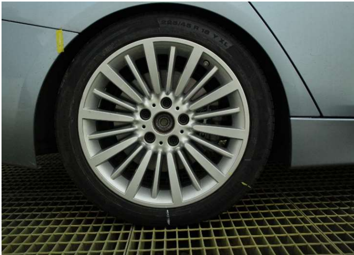
Striche an der Reifenflanke halfen, die Position des Reifens während der Aufheiz- (Kabine) und der Abkühlphase (Hof) genau aufeinander abzustimmen. Quelle: KTI.
